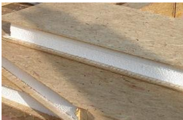
Рис. 7. Конструкционно-изоляционная панель (SIP)
